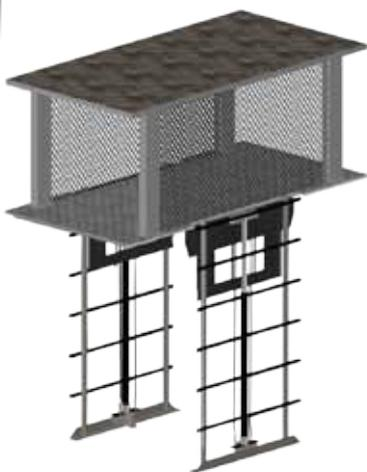
Ascensore per auto a colonne laterali, corsa massima 10.5 m, Struttura e pianale in acciaio zincato a caldo. Modello dotato di copertura carrabile e pavimentabile. Portata 2500-5000 Kg Fossa di alloggiamento 150 cm, tensione di alimentazione trifase 380 V, disponibili in 3 versioni (a richiesta, personalizzabili).
