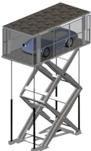
Ascensore per auto a doppio pantografo, corsa massima 6 m, Struttura e pianale in acciaio zincato a caldo. Modello dotato di copertura carrabile e pavimentabile Portata 5000 Kg Fossa di alloggiamento 93 cm, tensione di alimentazione trifase 380 V, disponibili in 3 versioni (a richiesta, personalizzabili).
