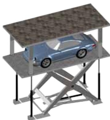
Ascensore per auto a pantografo, corsa massima 3.5 m, Struttura e pianale in acciaio zincato a caldo. Modello dotato di copertura carrabile e pavimentabile Portata 2500-5000 Kg Fossa di alloggiamento 57 cm, tensione di alimentazione monofase 220, trifase 380 V, disponibili in 3 versioni (a richiesta, personalizzabili).
