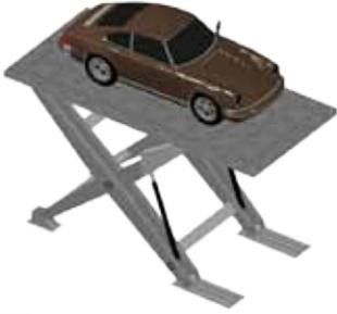
Ascensore per auto a pantografo, corsa massima 3.5m, Struttura e pianale in acciaio zincato a caldo. Portata 2500 Kg (disponibile anche con portata 3500 Kg). Fossa di alloggiamento 55-70 cm, tensione di alimentazione 220-380 V, disponibili in 3 versioni (a richiesta, personalizzabili).
