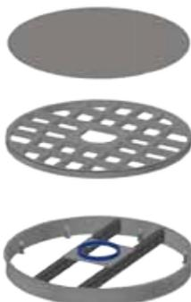
La piattaforma girevole è stata studiata per risolvere il problema di manovra permettendo alla vostra auto di ruotare su se stessa in qualsiasi direzione. Interamente zincata a caldo. Possibilità di essere pavimentata. La fossa necessaria è di 40/43 cm e i diametri variano da 350-500 cm. Tensione di alimentazione monofase 220 V.
