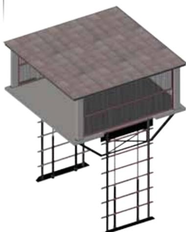
Doppio parcheggio lineare a scomparsa con sistema di elevazione a colonne laterali, completo di tetto di copertura a tenuta stagna e pavimentabile. Struttura e pianale in acciaio zincato a caldo. Portata per ogni singolo posto 2500 Kg. Fossa necessaria 350 cm. Tensione di alimentazione trifase 380 V.
