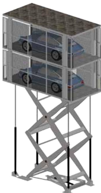
Parcheggio doppio a scomparsa con sistema di elevazione a pantografo. Struttura e pianale zincati a caldo. Tetto di copertura a tenuta stagna e pavimentabile. Portata posto auto 2500 Kg. Fossa necessaria 520 cm. Tensione di alimentazione trifase 380 V. Disponibile in 3 versioni (a richiesta personalizzabili).
