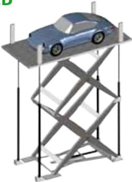
Ascensore per auto a doppio pantografo azionato da 5 cilindri idraulici, corsa massima 6m. Struttura e pianale interamente zincati a caldo. Fossa di alloggiamento 93cm. Tensione di alimentazione trifase 380V. Disponibile in 3 versioni (a richiesta, personalizzabili).
