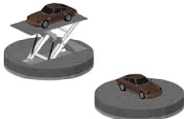
Ascensore per auto a pantografo, corsa massima 3.5 m. struttura e pianale in acciaio zincato a caldo. Portata 2500 Kg. Questo modello, ruotando permette l'accesso ad autorimesse non in linea con l'asse del sollevatore. Fossa necessaria 150 cm. Tensione di alimentazione trifase 380 V.
