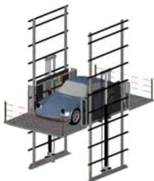
Ascensore per auto dotato della certificazione "conducente a bordo", caratterizzato da un sistema di sollevamento a colonne laterali. Corsa massima 11.5m. Pianale completamente zincato a caldo. Portata 2500-5000 Kg. Fossa di alloggiamento 25-100 cm. Tensione di alimentazione 220-380 V. Disponibil in 3 versioni (a richiesta, personalizzabili).
