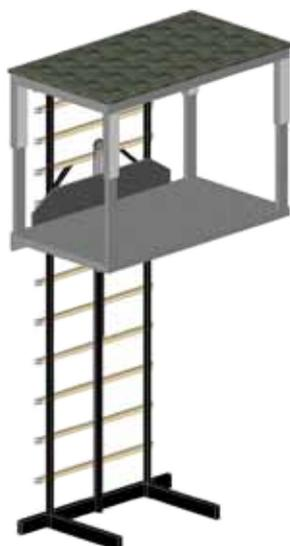
Piattaforma a colonna studiata per il trasporto di merci, dotata di tetto di copertura carrabile e pavimentabile, con livelli di fermata definiti. La struttura e il pianale sono in acciaio zincato a caldo. Portata massima 1500 Kg. Fossa di alloggiamento minima 150 cm. Tensione di alimentazione Monofase 220 V-Trifase 380 V.
