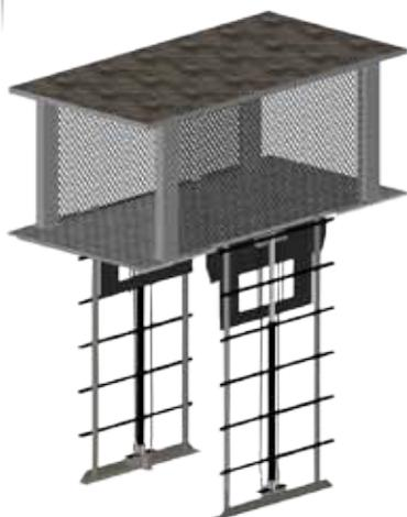
Piattaforma a doppia colonna studiata per il trasporto di merci , dotata di tetto di copertura carrabile e pavimentabile, con livelli di fermata definiti. La struttura e il pianale sono in acciaio zincato a caldo. Portata massima 2500/5000 Kg. Fossa di alloggiamento minima 150 cm. Tensione di alimentazione Monofase 220 V-Trifase 380 V.
