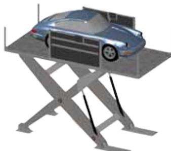
Ascensore per auto a pantografo, dotato della certificazione "conducente a bordo" corsa massima 3.5m, Struttura e pianale in acciaio zincato a caldo. Portata 2500 Kg (disponibile anche con portata 3500 Kg). Fossa di alloggiamento 55-70 cm, tensione di alimentazione 220-380 V, disponibili in 3 versioni (a richiesta, personalizzabili).
