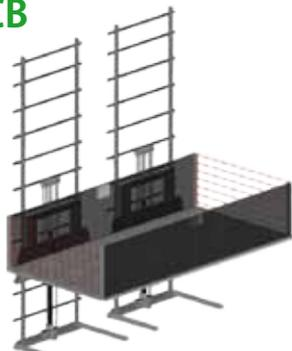
Ascensore per auto dotato della certificazione "conducente a bordo", caratterizzato da un sistema di sollevamento a colonne laterali posizionate sullo stesso lato per un minore ingombro in larghezza. Corsa massima 11.5m, struttura e pianale completamente zincati a caldo, portata 2500/3000 Kg. Fossa di alloggiamento 25-100 cm. Tensione di alimentazione 220-380 V.
