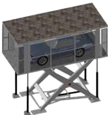
Parcheggio singolo a scomparsa con sistema di elevazione a pantografo. Struttura e pianale zincati a caldo. Tetto di copertura a tenuta stagna e pavimentabile. Portata 2500-5000 Kg. Fossa necessaria 270 cm. Tensione di alimentazione monofase 220-trifase 380 V. Disponibile in 3 versioni (a richiesta personalizzabili).
