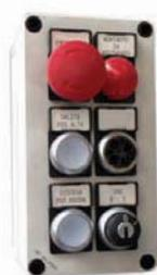
Pulsantiera di comando fornita di serie, con grado di protezione IP 65, composta da pulsanti con comando "ad uomo presente" e selettore a chiave asportabile.
