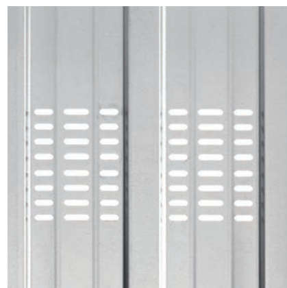
Lamiera grecata fori ovali multipli di 4 file, manto completamente forato con aerazione circa 11%.
